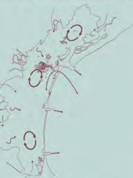
L'un des objectifs à poursuivre est le rééquilibre entre les courants venant à l'intérieur du lagon depuis les criques du Lido et de Malamocco, maintenant caractérisée par une disparité sensible. L'eau venant des marées va s'introduire dans les éléments créés emprisonnant les sédiments suspendus par le mouvement de l'eau.
